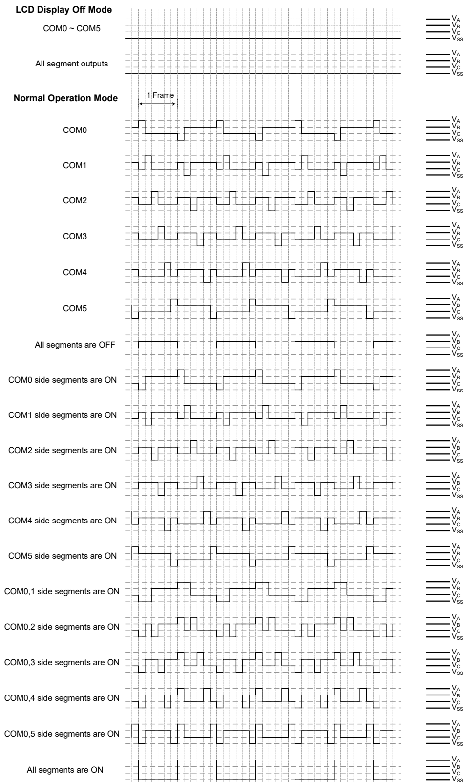
LCD 驱动输出 – B 型, 1/6 Duty, 1/3 Bias
