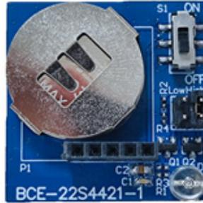
2. 插入雷达模块，天线一面朝外，打开电源开关。
