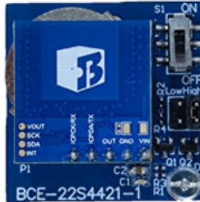
3. 使用双面海绵胶之类的胶布，将演示板贴在墙面、天花板或者稳定物体上(安装时请阅读注意事项)，模块天线朝向待测区域。
